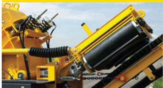
Эффективное удаление металлических включений при помощи магнитного сепаратора, установленного поперечно направлению основного разгрузочного конвейера
