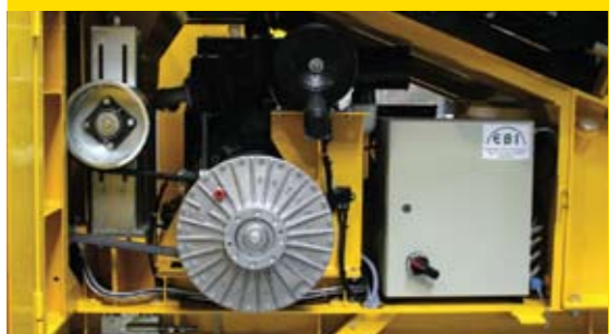
Незначительный расход топлива благодаря эффективной дизель-электрической концепции привода (ок. 12 л/ч)
