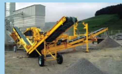
Совместное использование дробильной установки RM60 с виброгрохотом CS2500 позволяет достичь максимальной прибыли
