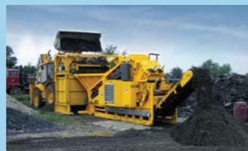
Минимальный износ дробильной камеры, благодаря совместному использованию установки RM60 с виброгрохотом предварительного отсеивания VS60
